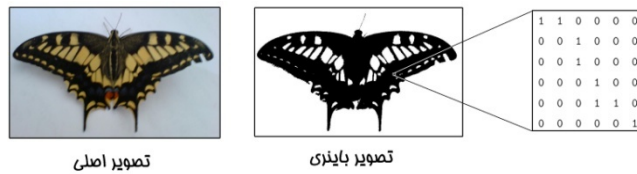
شکل ۳-۳- تبدیل تصویر فرضی رنگی به باینری [۲]
